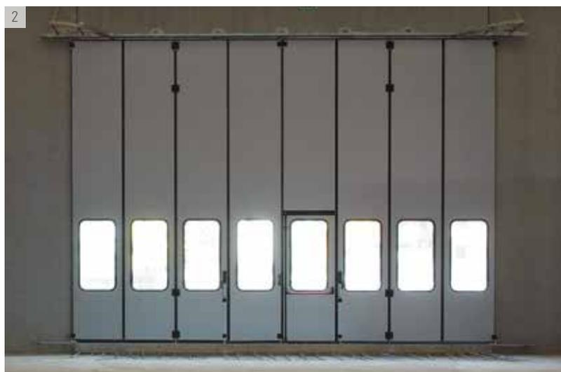
Il portone con guida a pavimento può essere motorizzato solo **con manovra a uomo presente**, non a distanza con radiocomando e la manovra di emergenza è prevista solo dal lato interno.
